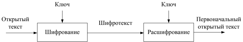
Рисунок 3 – Шифрование и расшифрование с одним ключом
